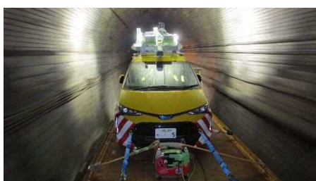
3次元点群データ計測車両 (伊豆急行線トンネル内)
