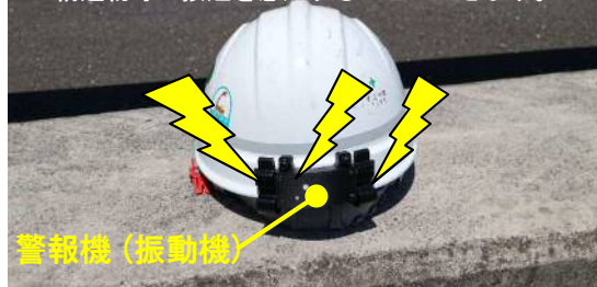
警報機（振動機）取付状況
