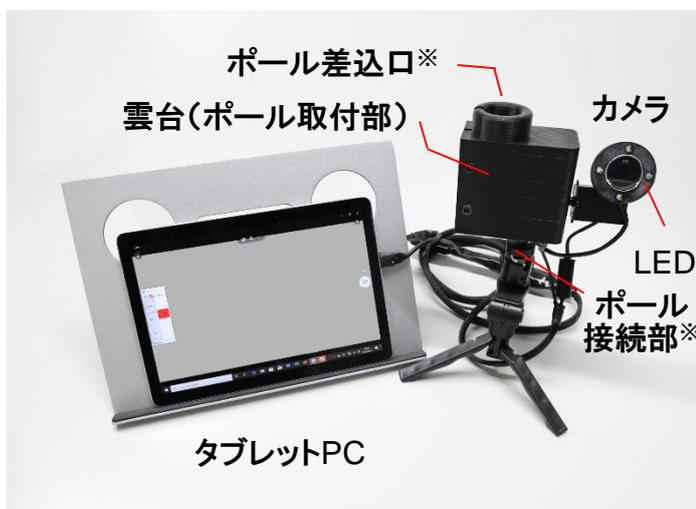
※ポールは、カメラねじ対応の直付と差込口を設けΦ30のポール取付が可能
