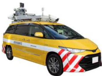
3次元点群データ計測車両
